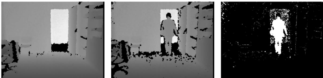
Rysunek 2.20. Operacja różnicy obrazów głębi. Od lewej: obraz tła, aktualny obraz głębi, różnica obrazów (zilustrowana w oparciu o obraz binarny).
