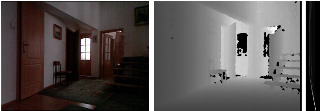
Rysunek 2.12. Metoda v - disparity zastosowana dla danych z sensora Kinect , od lewej: obraz RGB sceny, mapa głębi, obraz v -dysparycji.
