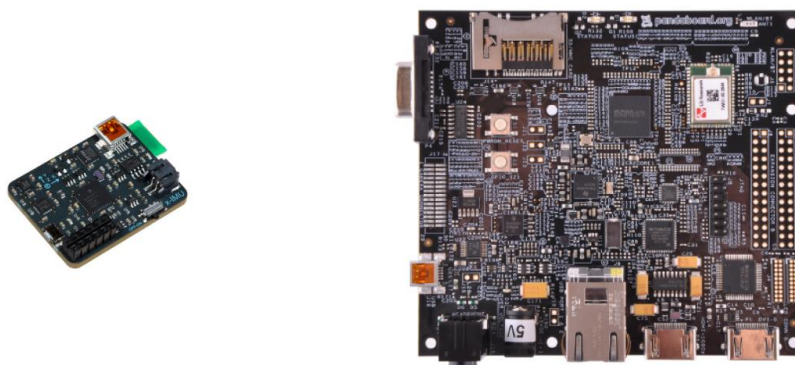
Rysunek 2.8. Urządzenia wykorzystane w pracy: po lewej sensor x-IMU, po prawej platforma mobilna PandaBoard ES .
